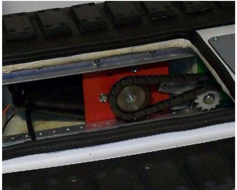
Abb. Antrieb mit Kettenübersetzung
