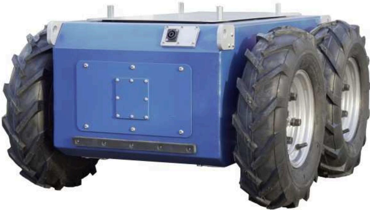
CU-CHASSIS-XT 4WD Carrier Träger- Transportfahrzeug
