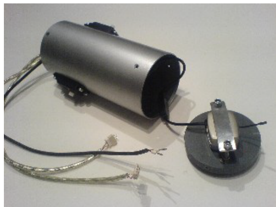
Abb. In Kamerarohr montierte Funkkamera
