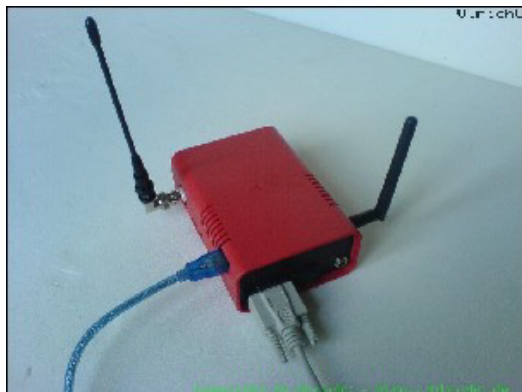
Abb. Gehäuse mit Integrierter Funkübertragung (Steuersignale und Video)
