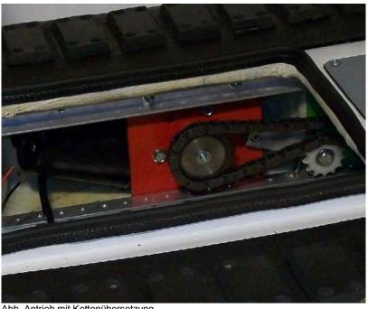
Abb. Antrieb mit Kettenübersetzung
