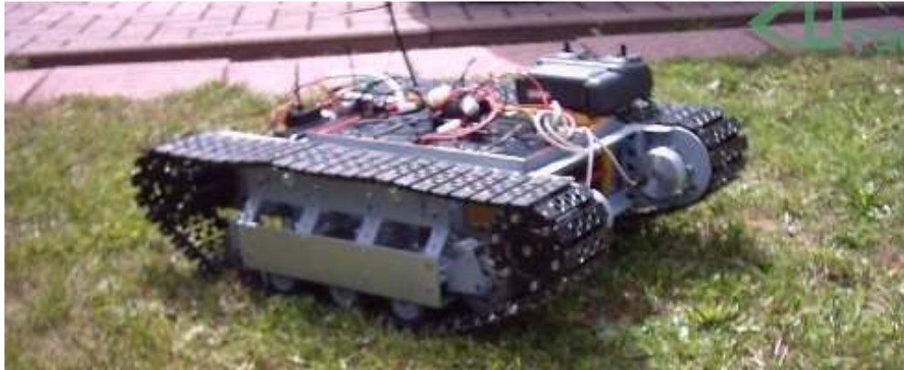
Abb. Roboterfahrgestell während der Entwicklung mit RC-Fernbedienung.
