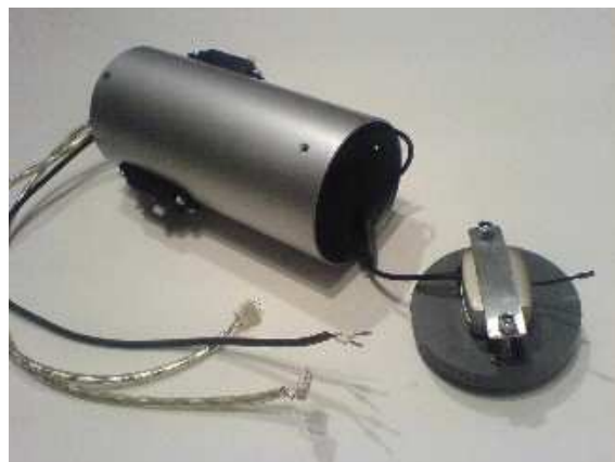
Abb. In Kamerarohr montierte Funkkamera
