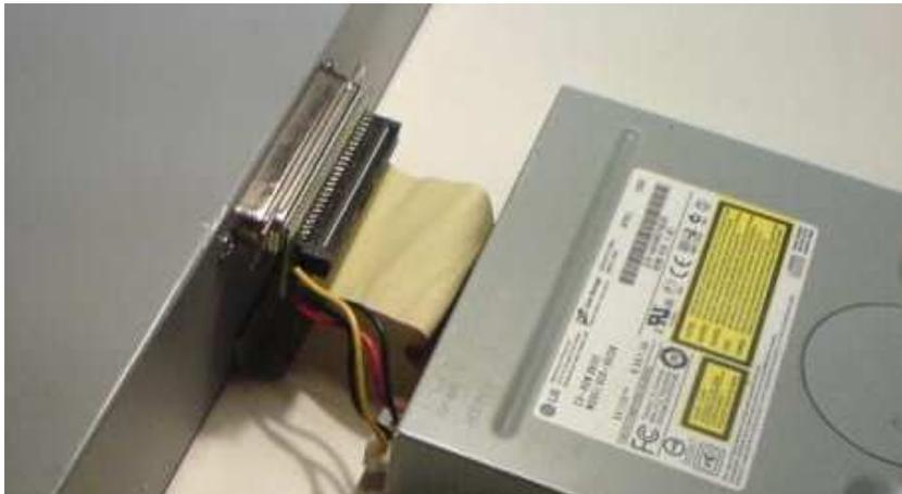
Der IDE-Anschluss selbst, wurde aus einem Wechselgehäuse für Festplatten ausgebaut und ohne nennenswerte Änderungen verwendet.
