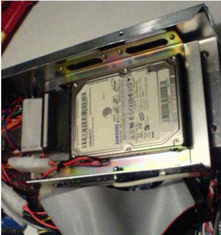
Abb. 3,5" Einbauschacht mit 2,5" Festplatte
