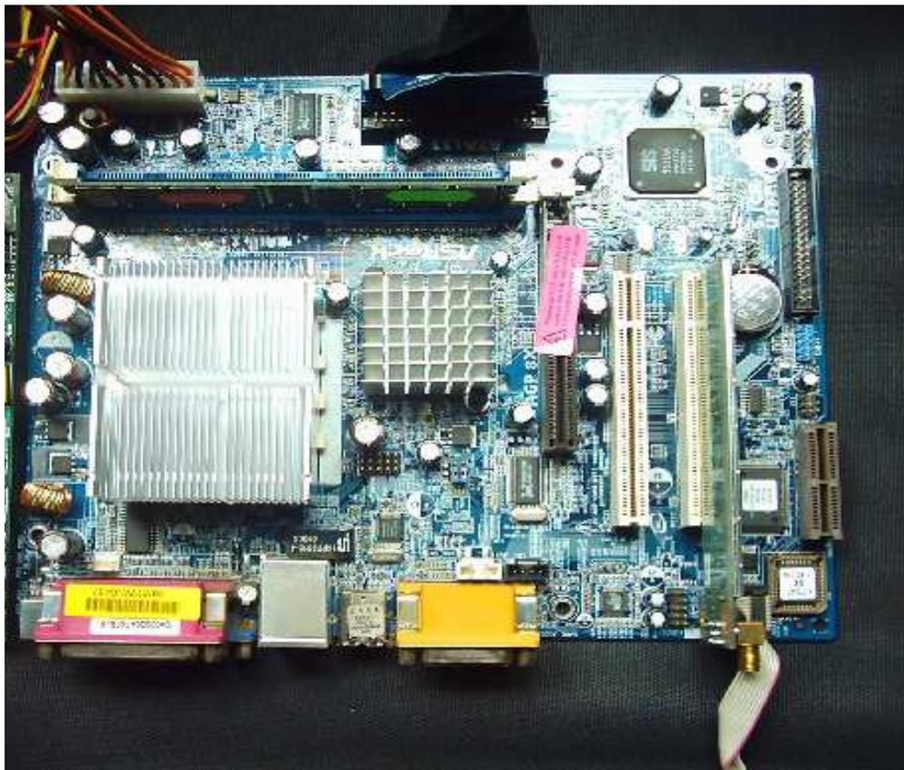
Das Micro-ATX-Mainboard hat die Abmessungen 245 mm x 198 mm und wird zusammen mit der weiteren PC-Hardware in einem Gehäuse auf dem Roboter montiert.
