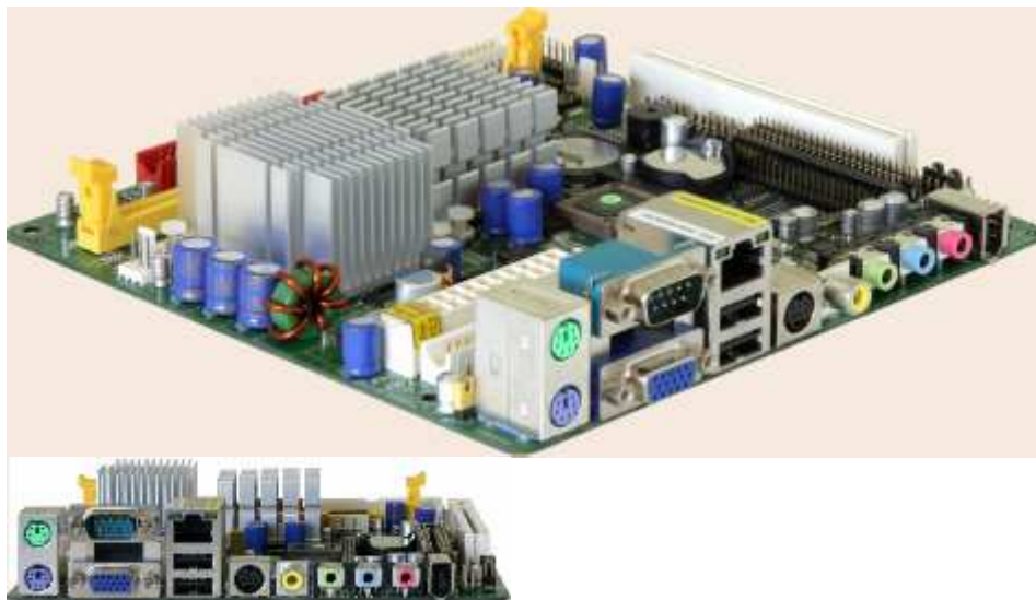
Abb.: Mini-ITX-Mainboard (170 mm x 170 mm)
