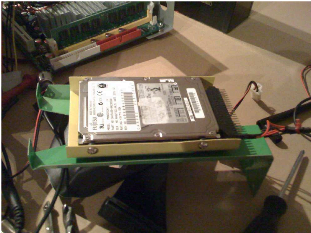
Abb. 2,5" Einbauschacht mit 2,5" Festplatte
